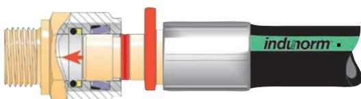
Der Stecker wird vollends eingesetzt, bis der Montageanschlag an der Steckbuchse anliegt.
