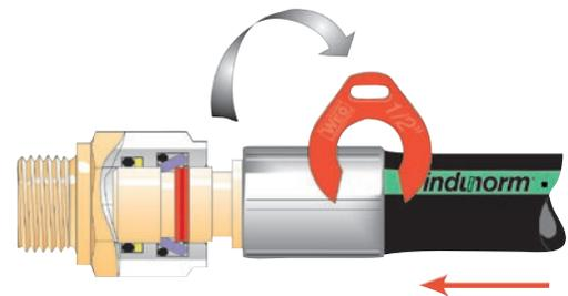
Nehmen Sie einen Schraubendreher, um den Montageanschlag zu entfernen.
