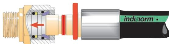
Der Stecker wird in die Steckbuchse eingesteckt, so dass die Sicherungshaken nach außen gepresst werden.
