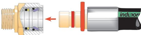
Prüfen Sie den Montageanschlag auf richtigen Sitz und die Beweglichkeit des Demontierings in seiner Nut.
