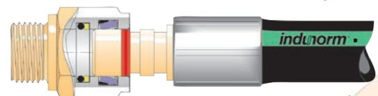
Ziehen Sie den Stecker heraus, so dass sein äußerer Flansch den Demontiering berührt. Dann ziehen Sie ihn nach hinten, damit die Sicherungshaken gelöst und der Stecker vollständig herausgezogen werden kann.
