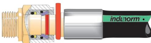
Der O-Ring der Sicherungshaken federt die Sicherungshaken zurück, so dass sie am Flansch des Steckers einrasten. Die Kupplung ist nun gesichert und kann nicht auseinandergezogen werden.
