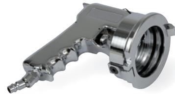
Kernstück des Systems ist die ergonomisch geformte Pistole aus hochfestem Aluminium. Die verchromte und robuste Ausführung garantiert eine lange Lebensdauer. Der Leistungsbereich umfasst Schläuche von DN 06-50 sowie Rohre mit einem Außendurchmesser von 6 mm bis 65 mm. Zur besseren Bedienung sind die Geräte mit einem drehbaren Druckluftanschluss versehen.
